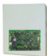
Modulo controllo accessi per 1 lettore con collegamento su BUS. Consente l'accesso e/o l'inserimento e disinserimento del sistema con sola scheda, con solo codice, oppure con scheda e codice. Comando automatico sblocco porta, opzioni per porta aperta e per porta forzata, temporizzazioni per sblocco porta e per ritardo esteso, sblocco porta manuale con pulsante o uscita programmabile, opzione sblocco porta su allarme incendio. Fornito in armadio metallico mm 200x255x76. Richiede trasformatore.
