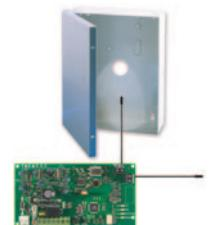
Ripetitore radio per la ripetizione dei segnali provenienti dai sensori senza fili, dai telecomandi, dalle tastiere senza fili e dai moduli PGM senza fili. Completamente supervisionato dalla centrale che rilascia un'apposita segnalazione per mancanza rete e batteria bassa. Dispone di un ingresso zona (N.A./N.C.). Richiede trasformatore TF40/16 230Vc.a. e batteria. Versione 433MHz.
