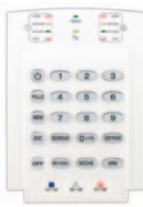
Tastiera con indicatori LED 10 zone e sportello verticale di protezione dei tasti, indicatori LED separati per la visualizzazione dello stato d'inserimento Totale, Notturno, Perimetrale e Disinserito di ciascuna delle 2 aree. Possibilità di regolazione della luminosità. Collegamento su BUS (max. 15 tastiere). 1 ingresso di zona.
