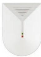
Rivelatore acustico di rottura vetri, con sensibilità regolabile: copertura fino a m 9 con sensibilità alta, e fino a m 4,5 con sensibilità bassa. Analisi completa dello spettro acustico ad infrasuono, filtri digitali su 7 frequenze, amplificatore digitale di guadagno e valutazione della variazione di frequenza, alta immunità alle interferenze EMI e RFI con filtro digitale.
