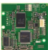
Modulo combinatore vocale. Chiama fino a 5 numeri telefonici (8 con le centrali DIGIPLEX EVO) per riportare un allarme intrusione, aggressione, incendio, mancanza e ripristino rete e batteria bassa centrale utilizzando messaggi vocali. Personalizzazione di un messaggio vocale di 15 secondi. Permette l'inserimento/disinserimento del sistema e l'attivazione delle uscite programmabili a distanza tramite qualsiasi telefono. Inserimento ad innesto sulla scheda della centrale.
