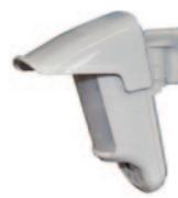
Rivelatore digitale indirizzabile per esterno a doppia tecnologia, doppio PIR e microonda con funzione antimascheramento e antirisciamento. Portata m 15 x 15 angolo 90°, interruttore antomanomissione e antirimozione. Grado di protezione IP55. Elevata immunità animali domestici regolabile 10Kg, 15Kg e 20Kg.
