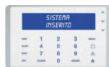
Tastiera a sfioramento Touch Sense con visualizzatore alfanumerico LCD con retroilluminazione colore blu ad alta visibilità, 2 righe di 16 caratteri con scritte programmabili, design compatto e affusolato, 14 tasti ad attivazione singola, 3 tasti ad attivazione rapida per allarme emergenza. Programmazione degli avvisatori acustici in modo indipendente per ciascuna zona. Collegamento su BUS. 1 zona indirizzabile e 1 uscita programmabile. Colore bianco.
